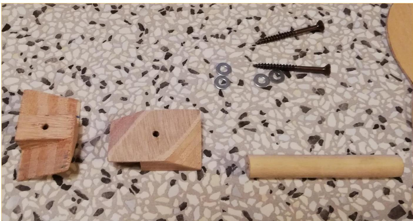
**Dettaglio dei mozzi, del tondino di sostegno e delle viti**
