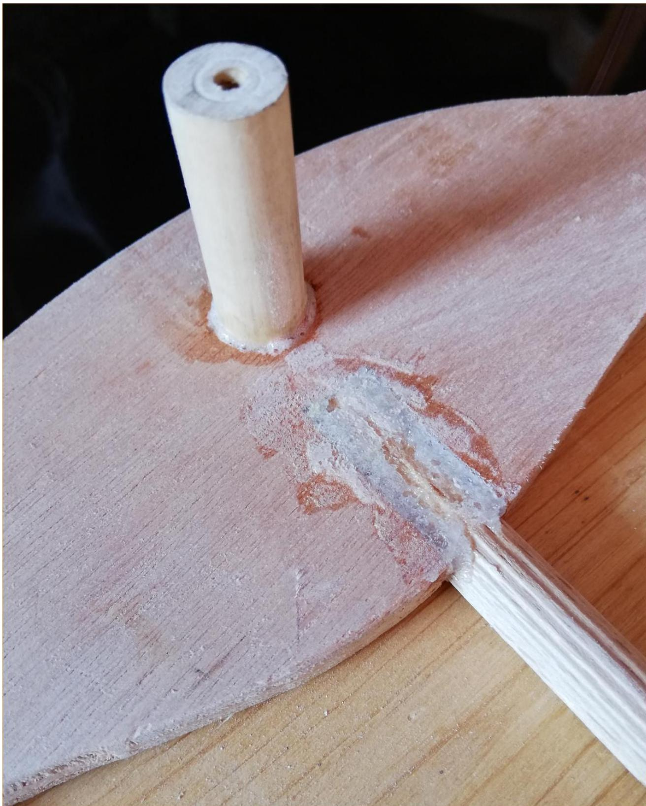
Particolare del tondino di supporto delle ali-elica e del tondino di sostegno (usata colla Mastro d'ascia)
